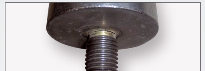
Pęknięcie na trzpieniu gwintowanym
