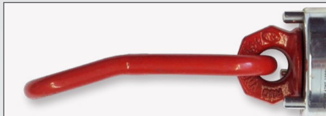
Zdeformowane ogniwo łączące
