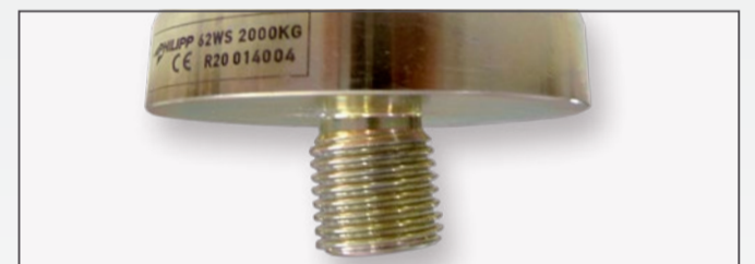
Odształcenie trzpienia gwintowanego
