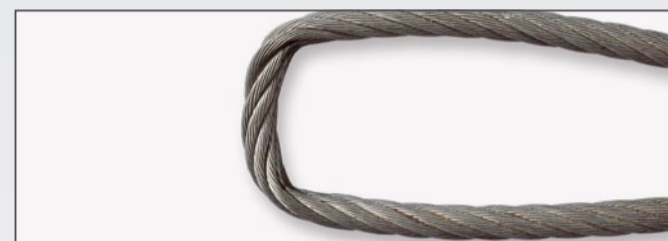
Uszkodzenie w obszarze wsparcia pętli
