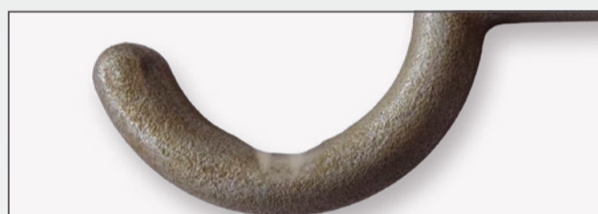
Zużycie sworznia blokującego
