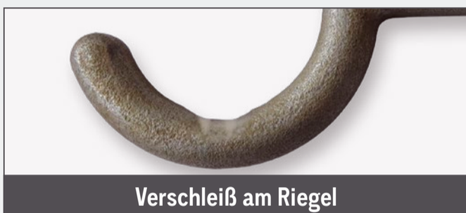
Quetschungen im Auflagebereich
