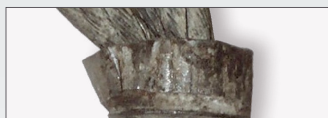
Uszkodzony zacisk łączący linkę
