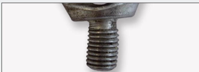
Odształcenie trzpienia gwintowanego
