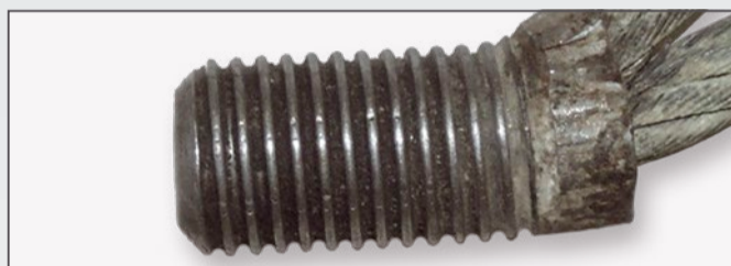
Uszkodzona część gwintowana
