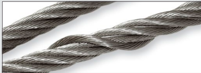
Lockerung der Außenlage
