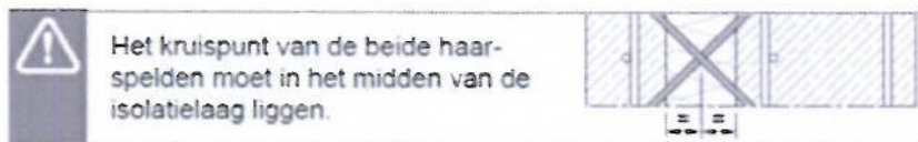
Figuur 9 Inbouwdiepten van het draaganker VNK
